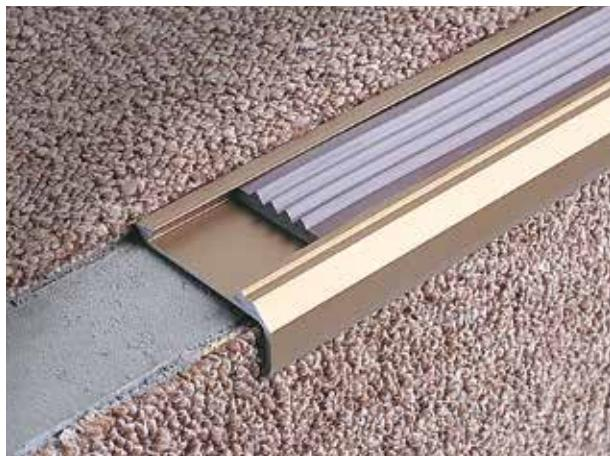
Stairtec SM es un peldaño con estructura en aluminio o latón e inserto antideslizante reemplazable en resina sintética, suministrado en varios colores, en la versión lisa o estriada. Ideal para rematar y proteger los bordes de peldaños revestidos en moquetas o goma.
